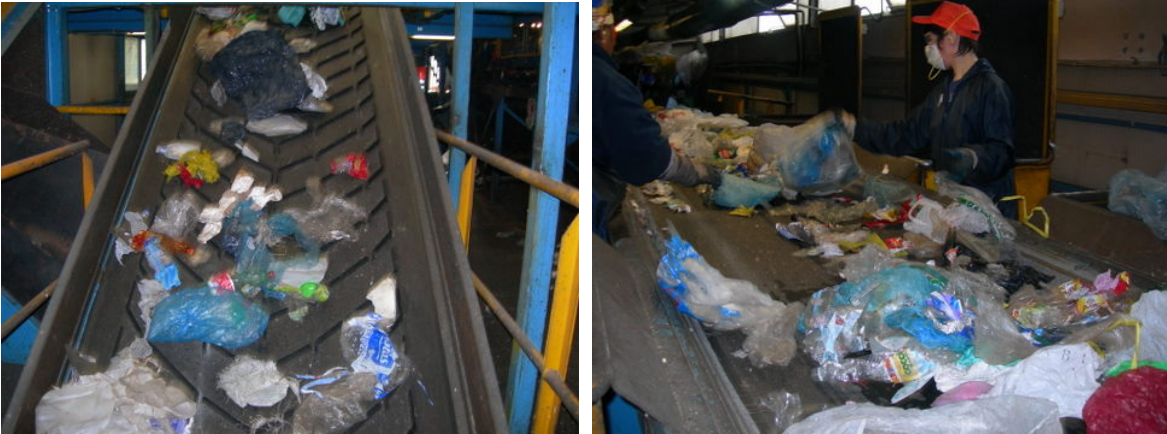
Fig. 4.1: Nastro trasportatore e cernita manuale del rifiuto.
