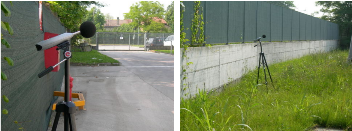
Fig. 6.2: Fonometro posizionato per la rilevazione dell'inquinamento acustico.
