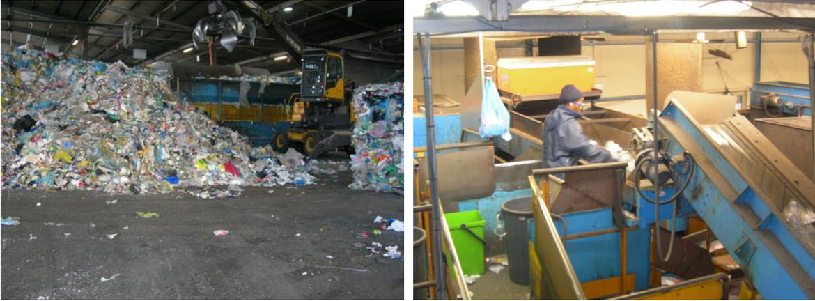
**Fig. 4.5:** Carico del rifiuto sfuso nella tramoggia e selezione manuale presso la cabina di cernita.
