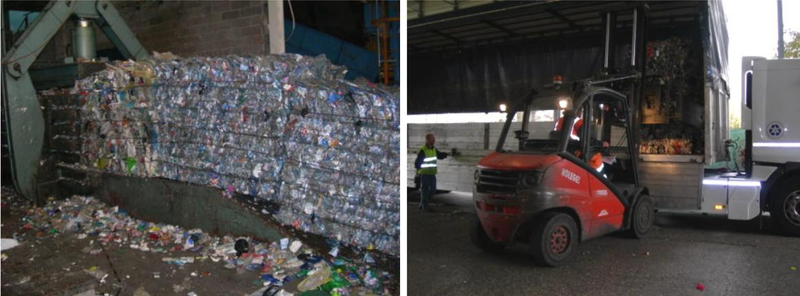
FIG. 5.4: Rifiuto lavorato in uscita dalla pressa e carico nel camion per avviarlo all'impianto di recupero finale.
